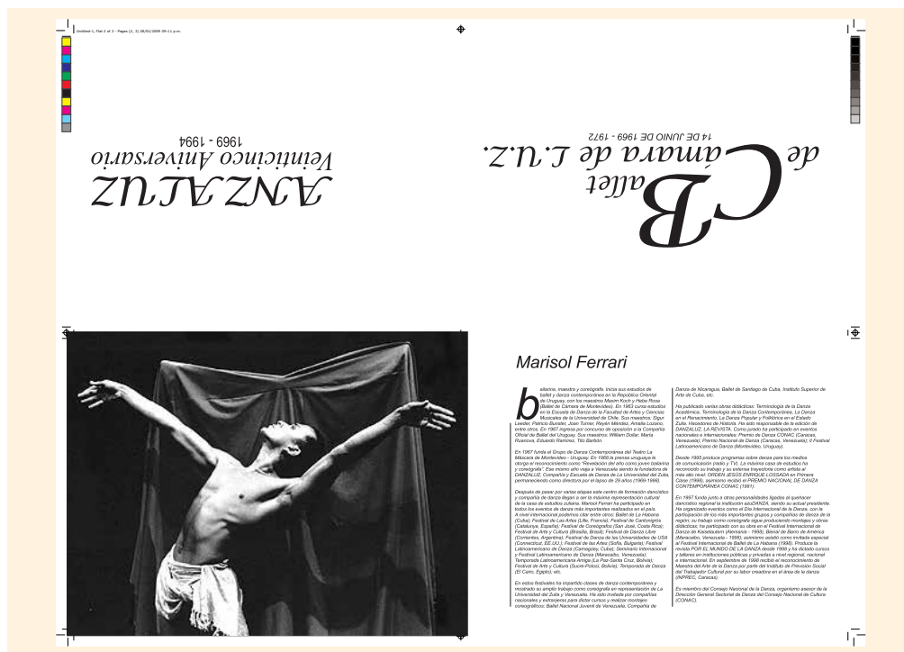
Impresión de un libro horizontal de un 1/8 vo de pliego 21.5 X 28 cm., utilizando medio pliego de papel.
